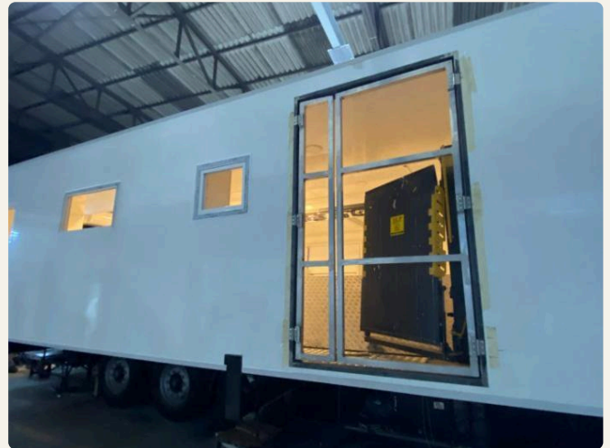
CAISSE EN ATELIER, OUVERTURES POSÉES
